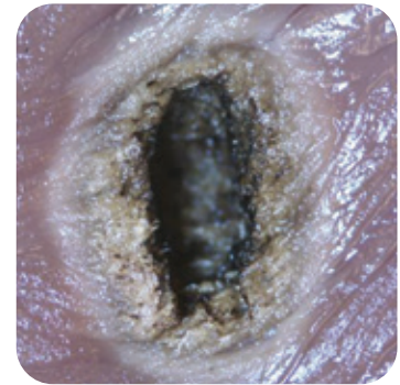
Figuras: Aspecto típico de los tratamientos de coagulación de FASTSEAL 6.0 (izquierda) y de un dispositivo de electrocauterio monopolar (derecha) en un modelo de tejido blando de miocardio bovino (corazón de res). 7
