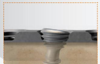
Die Laschen im Schraubenloch biegen sich und greifen in die Gewingänge des Verriegelungsschraubenkopfes
